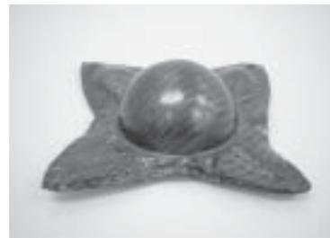
写真3 2次賦形後のCFRP
