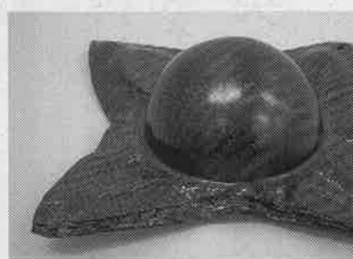
シート状CFRPをプレス成形することで半球状にも加工できる
