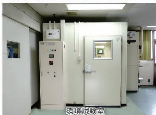
環境試験室 (様々な温度環境を再現し、性能試験や耐久試験をおこないます)
