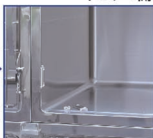
丁番などの金具を外して左右を逆にして取付ける
