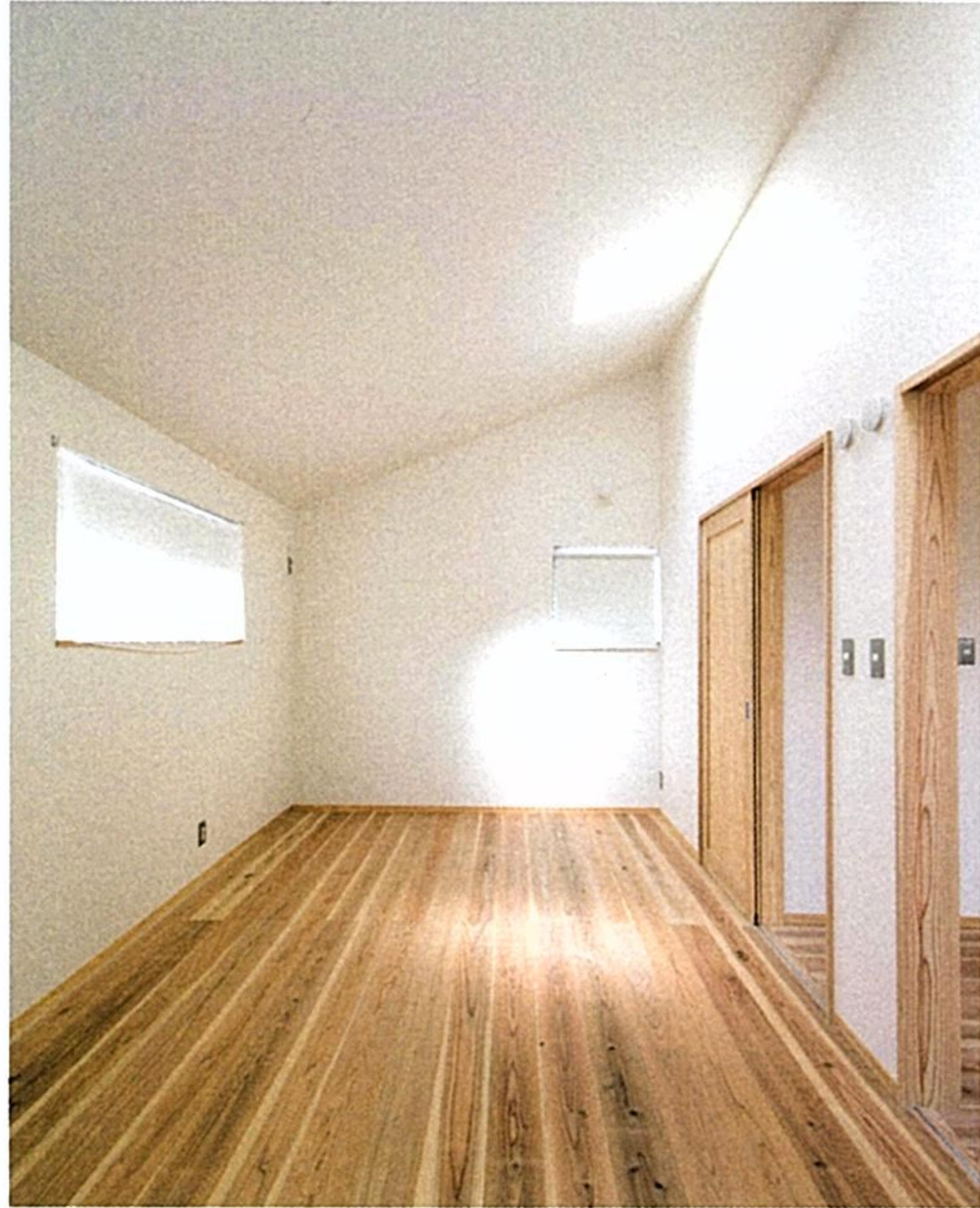
計算された勾配天井が空間に広がりを持たせる子ども部屋は、天窓で採光性に配慮。屋根や壁にはエコ素材の断熱材・セルローズファイバーを使用している。断熱性に優れ、防虫・防音・防火性も高く、快適な室温が保たれる。
